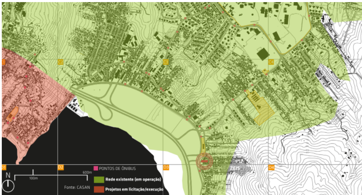
Imagem 56: Cobertura da rede coletora de esgoto sanitário na área do entorno do terreno em análise
